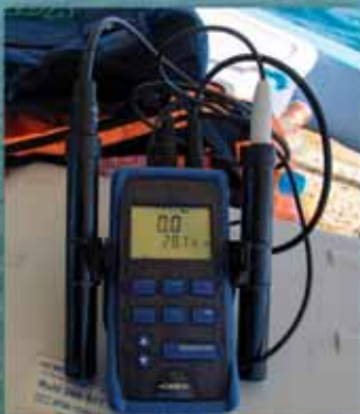
شكل يوضح جهاز السالينوميتر ويستخدم لقياس ( الملوحة ودرجة الحرارة و الأس الهيدروجيني للمياه)
