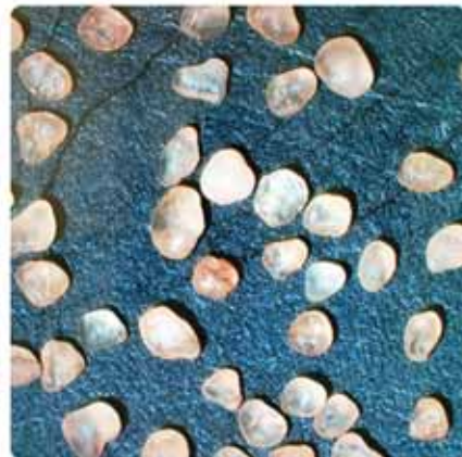
صورة أحد عينات لدراسة تحت الميكروسكوب (sphericity and roundness)
