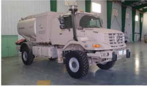
صورة توضح صهريج وقود الطائرات
