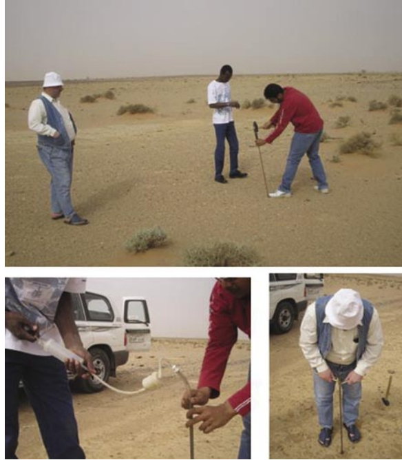
شكل (٦٦) : صورة توضح كيفية أخذ عينة قياس لغاز الرادون من التربة
