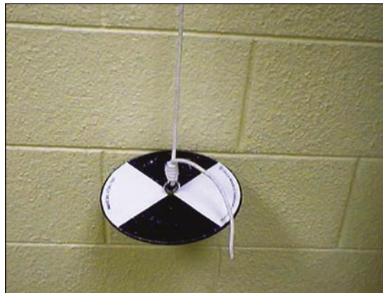
شكل (١٩) : قرص SDDD لمعرفة شفافية ونقاء مياه البحر
