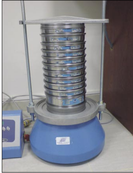
شكل (٢٠) : جهاز النخل والإحدى عشر منخل
