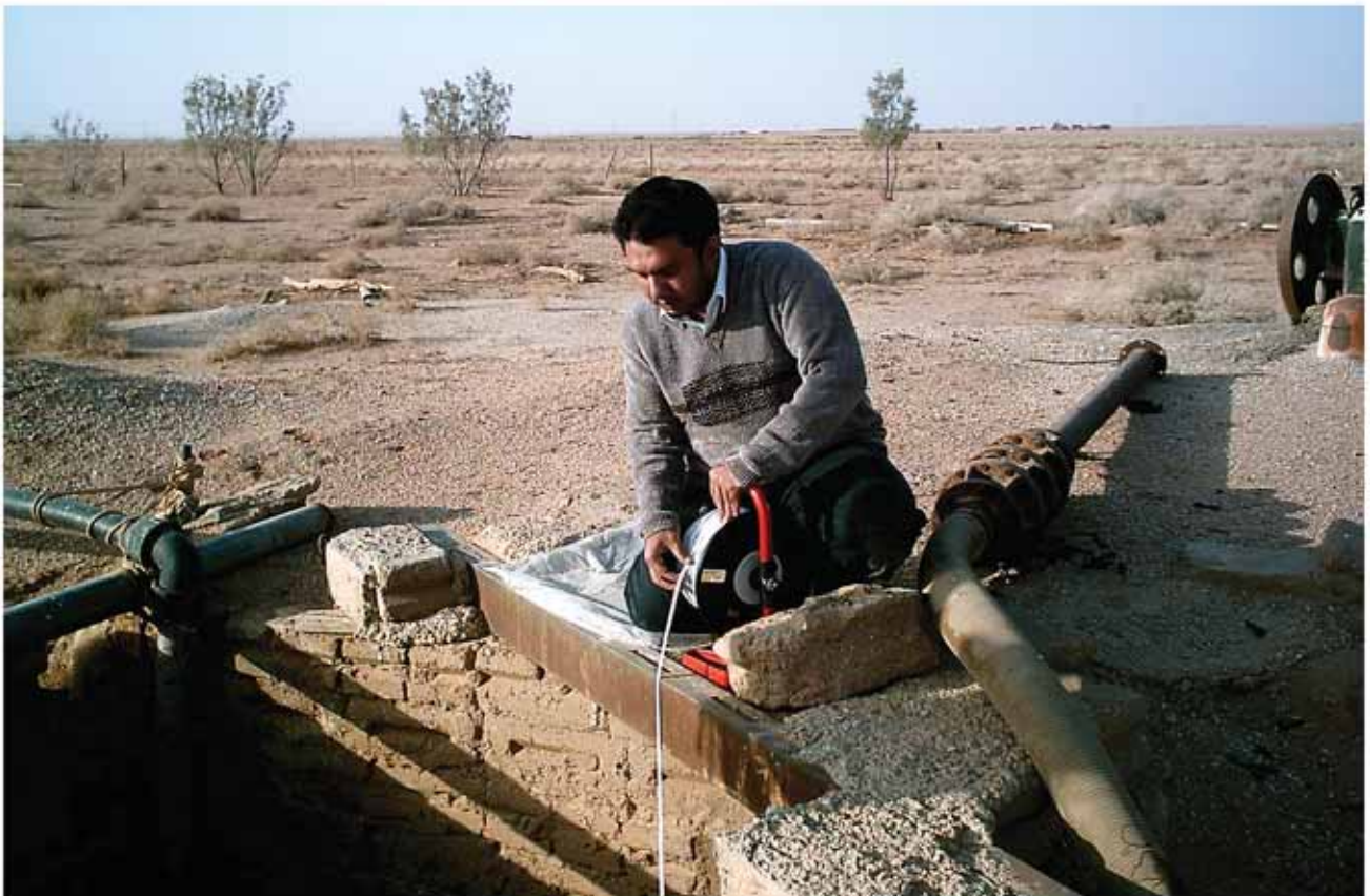
سورة توضح قياس مستوى المياه في أحد الآبار في وادي الدوادمي
