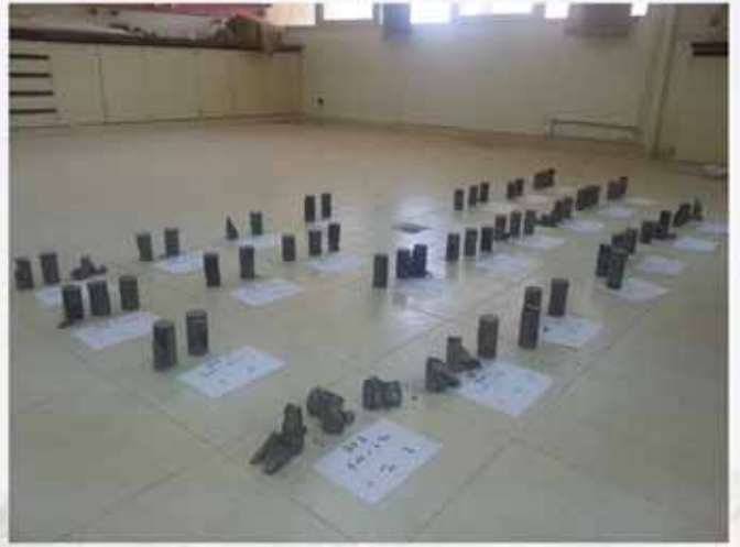
صورة توضح العينات المسخّرة بعد عمل تجربة قوة المسخور.
