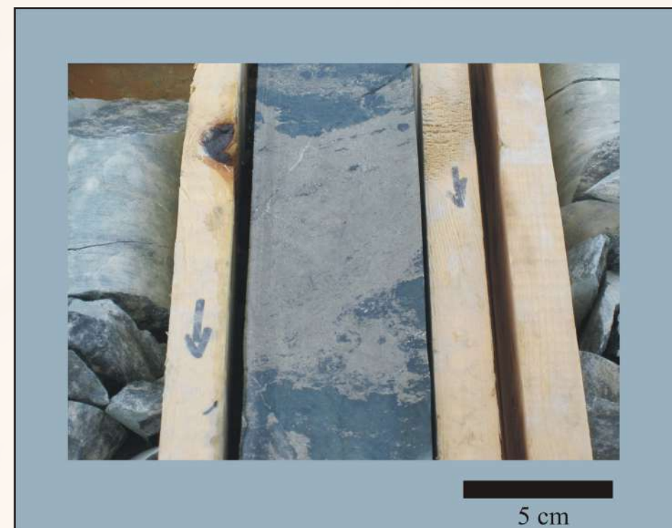
شكل رقم (٤٣) : صورة توضح وجود خام كبريتيدات الحديد الكتلية في الحفرة اللبية رقم ٣ في مكنم وادي الخضرة
