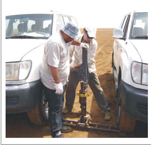
شكل (١٠٦): يوضح طريقة أخذ عينة غير مشوهة باستخدام جهاز Shelby tube
