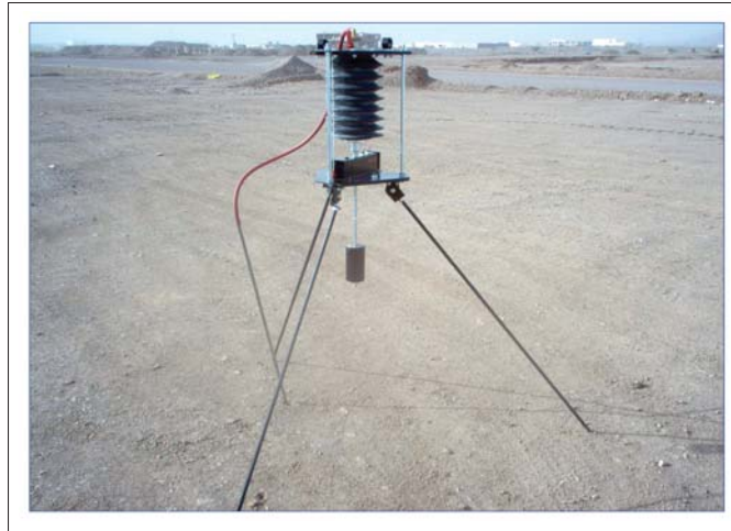
شكل (٩٩): طريقة اخذ القياسات باستخدام جهاز الرادون جوك
