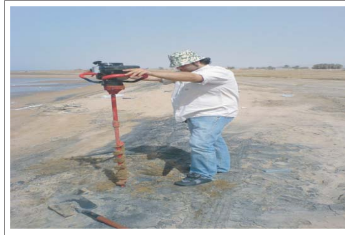
شكل (٦٤) : الحفر باستخدام جهاز الحفر Auger
