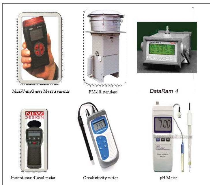
شكل (٧٨): الأجهزة الحقلية المستخدمة.
