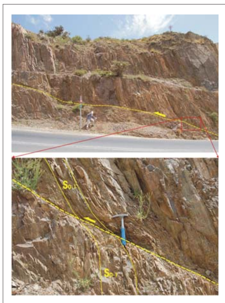
شكل (١١٤): قياس اتجاهات الفواصل الصخرية للقطع الصخري
