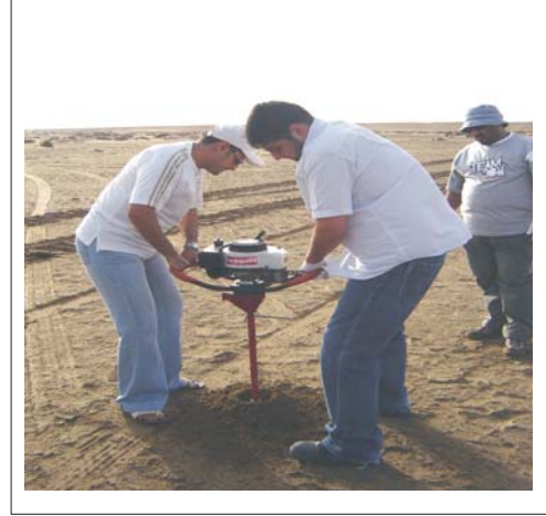
شكل (١٠٥): كيفية أخذ العينات للتربة باستخدام جهاز Power Auger
