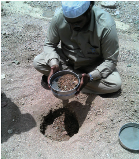
صورة توضح نخل العينات الجيوكيميائية في الحقل
