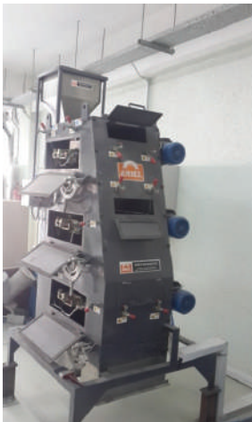
صورة لجهاز الفصل المغناطيسي rare earth magnetic separation والمستخدم في تنقية الرمال من أكسيد الحديد (Fe2O3) والشوائب الأخرى.
