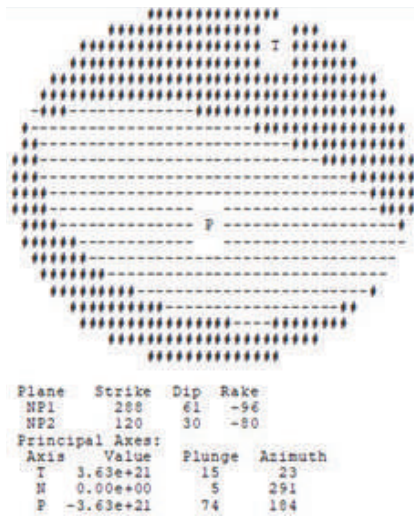
شكل 6: يوضح ميكانيكية حدوث الهزة الأرضية التي حدثت يوم 10/3/2017م بقوة 3.73 درجة على مقياس ريختر المتجه السيزمي العكسي
