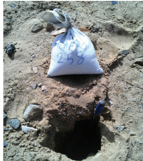
صورة توضح حفرة أخذ العينة الجيوكيميائية
