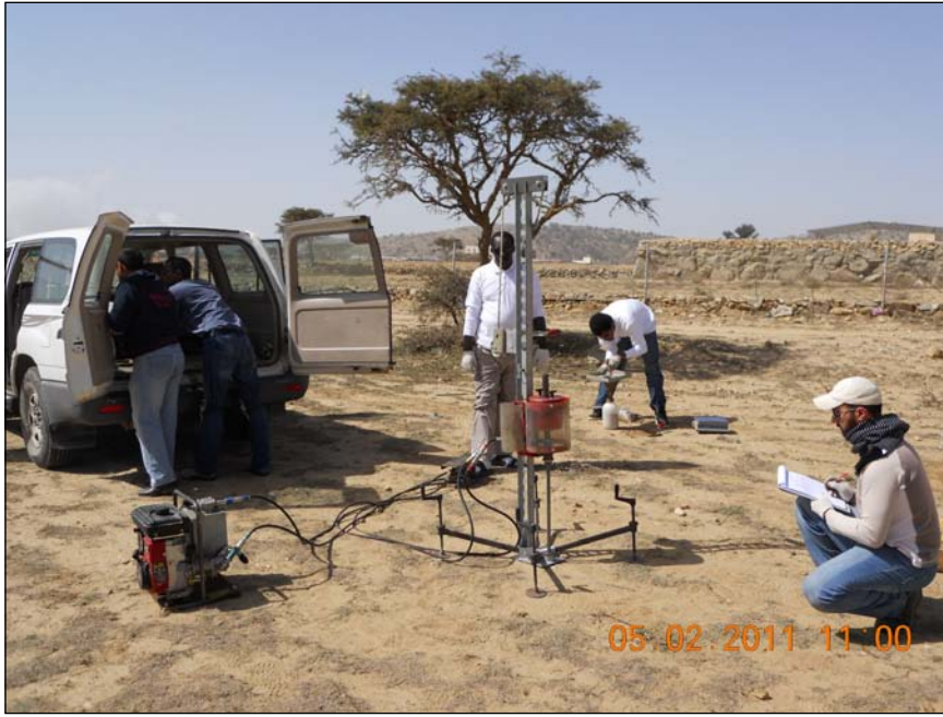
شكل رقم (٧٧): عمل تجربة عن مقاومة التربة للاختراق (CPT).
