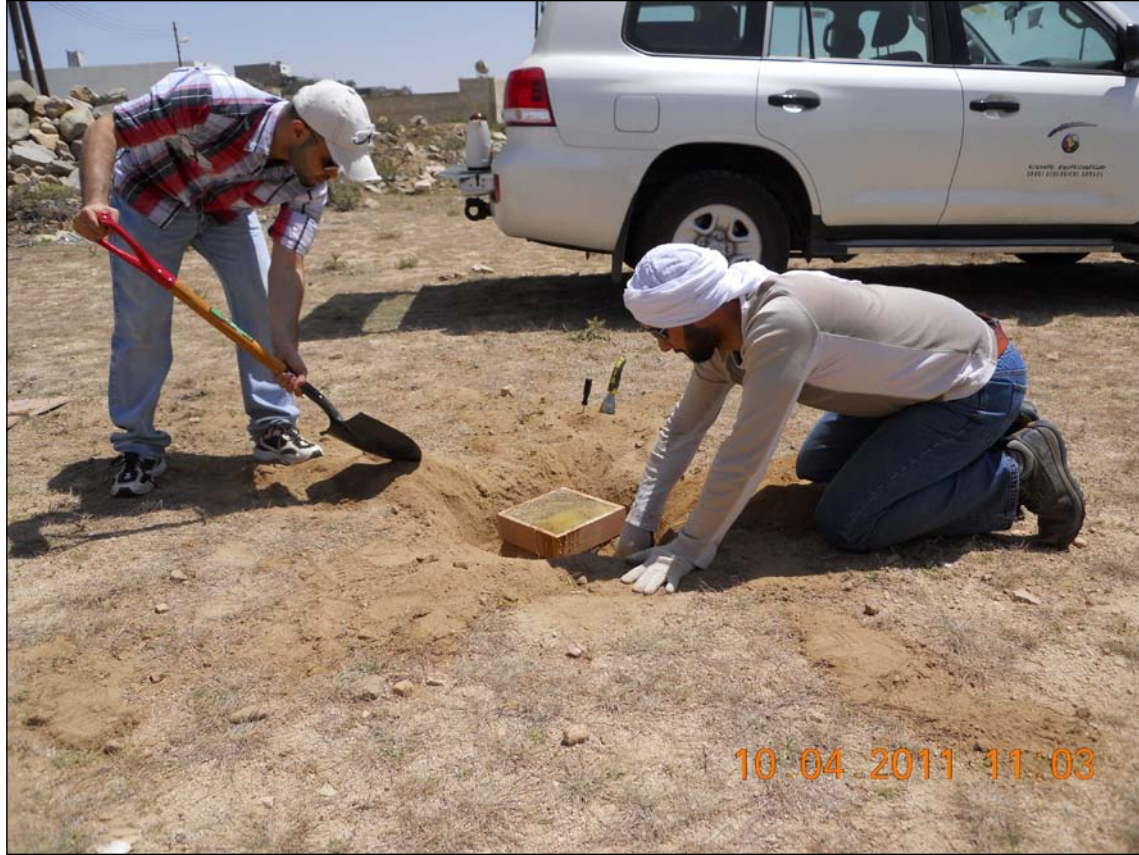
شكل رقم (٧٩): طريقة أخذ عينات غير مقلقة لقياس نفاذية التربة في المعمل .
